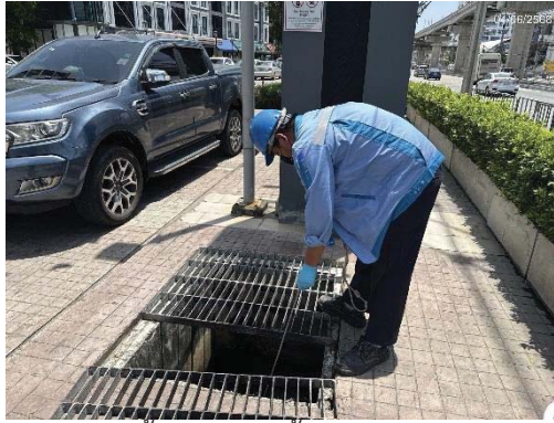
ภาพที่ 3.5.4-1 การเก็บตัวอย่างน้ำเสียบ่อบำบัดน้ำสุดท้ายก่อนปล่อยออกนอกโครงการ เฟส 3
